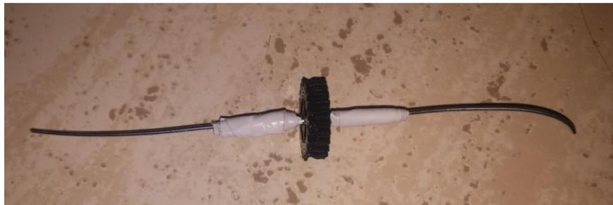
Como podemos apreciar hemos usado una rueda, alambre y cinta aislante. Por último para anclarlo a la estructura del robot lo haremos con silicona caliente.
