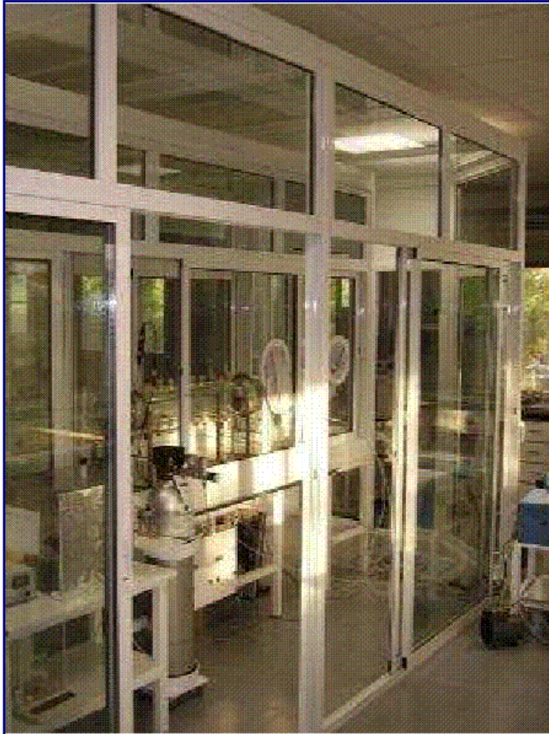
Figura III.12.- Doble cámara de vidrio. En el interior de la más pequeña se sitúa el sistema de calibración de gases.
