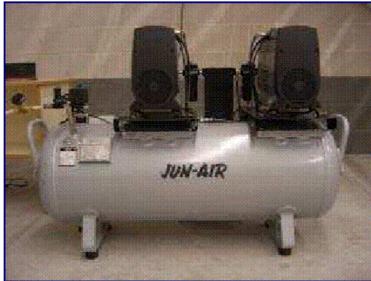
Figura III.2.- Vista frontal del compresor exento de aceite Jun-Air 2OF1202-150B D6.
