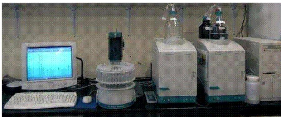
Figura 6.6. Cromatógrafo iónico Methrom 761 Compact IC
