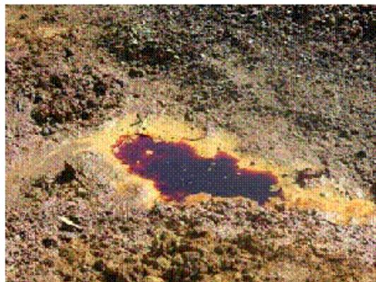
Figura 7.7. Precipitados formados al evaporar el agua en una balsa de estériles
