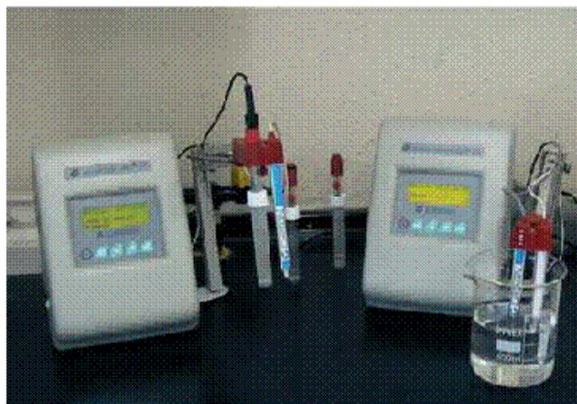
Figura 6.1. pHmetro y conductímetro
