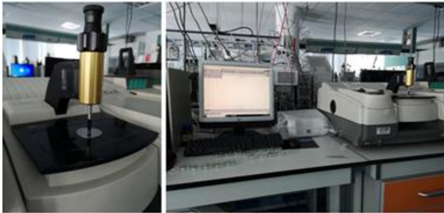
Figura 3.16. Espectrofotómetro infrarrojo “Thermo Nicolet 5700” del Servicio de Apoyo a la Investigación Tecnológica (SAIT) de la Universidad Politécnica de Cartagena (UPCT).
