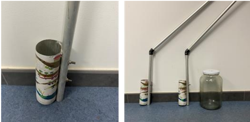
Figura 3.12. Dispositivos para la toma de muestras de agua residual y envase de vidrio con tapa metálica para su recolección y transporte.
