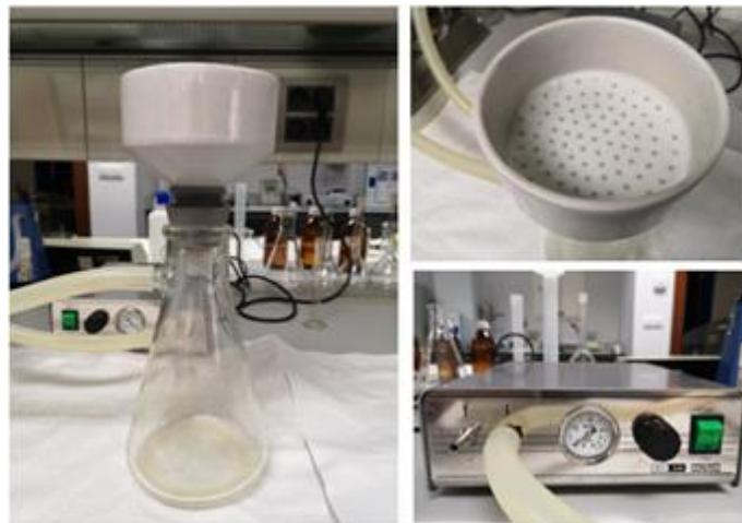
Figura 3.11. Material empleado en el método de filtración al vacío.
