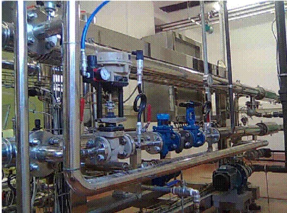
Figura 7.2: Válvula de control electroneumática
