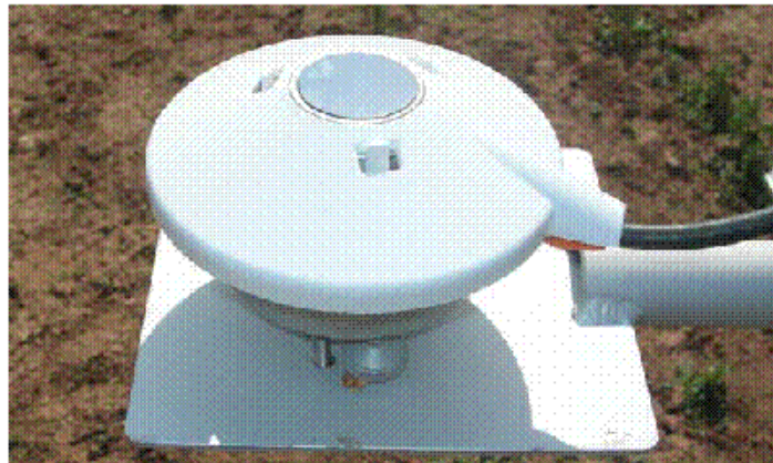
Figura 3.2.4. Pirgeómetro (Kipp & Zonen CGR3)
