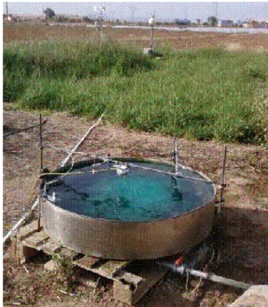
Figura 3.2.10. Tanque Clase A de la Estación meteorológica experimental ubicada en la Estación Experimental Agroalimentaria "Tomás Ferro" de la Universidad Politécnica de Cartagena.
