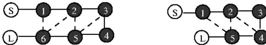
Figura 2.1: Esquemas de acoplo de redes canónicas (*folded - form*) de grado par e impar.
