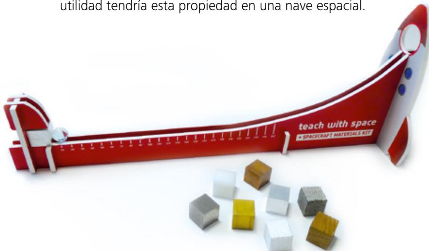
> Gráfico 6. Montaje para la prueba de resistencia a impactos.
