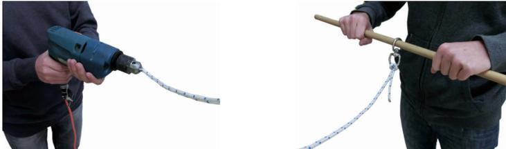
Aprisiona un extremo de la cuerda con el portabrocas del taladro y anuda el otro extremo al rodete. El giro de la otra parte del rodete se impide con la barra de madera, que debe sujetarse firmemente con las dos manos.
