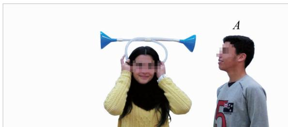
Una segunda persona se coloca a un lado de la primera, cerca de un embudo (posición *A*), comienza a hablar y, sin dejar de hacerlo, se desplaza por detrás de la persona que sostiene los tubos, hasta situarse cerca del segundo embudo (posición *B*).
