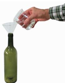
Mediante el embudo añade 225 mL, aproximadamente, de ácido clorhídrico comercial (hay que manejarlo con precaución, porque es corrosivo). La reacción con carbonato de calcio produce dióxido de carbono ( $\text{CO}_2$ ).
