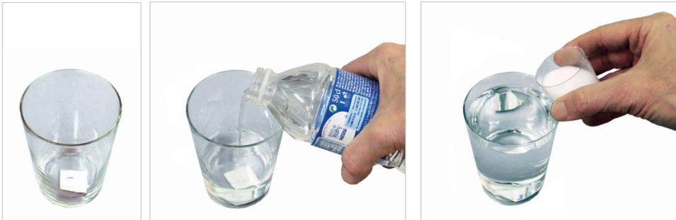
Pon el espejo (con su cara reflectante hacia arriba) en el fondo del vaso. Llénelo con agua y añade unas pocas gotas de leche para que el agua se vuelva levemente turbia. Finalmente, dirige hacia el espejo el rayo de luz que emite el puntero láser, apuntando con cierta inclinación hacia la superficie del agua.
