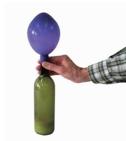
Retira el embudo, encaja rápidamente el globo en la boca de la botella y espera a que el globo se llene de dióxido de carbono.
