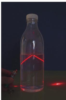
Observa que cuando la luz pasa del agua al aire ( $n_1 > n_2$ ), para un ángulo de incidencia determinado,  $i_c = \arcsen(n_2 / n_1)$ , la luz se refracta formando un ángulo de  $90^\circ$  respecto de la normal, por lo que no pasa al otro medio; si  $i > i_c$ , la luz se refleja y vuelve al medio de donde procede. Este fenómeno se conoce como *reflexión interna total* y es el fundamento de las fibras ópticas. El ángulo  $i_c$  se denomina ángulo de *reflexión interna total*.
