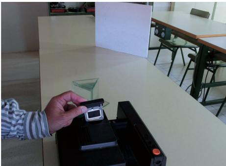
Coloca la superficie blanca, que actúa de pantalla, a cierta distancia del proyector. Pon el prisma junto al objetivo del proyector e inserta la diapositiva con la ranura vertical.
