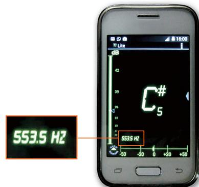
Abre la aplicación *DaTuner Lite* y sopla lateralmente por el extremo abierto del tubo (de forma análoga a como soplabas en la botella de la experiencia 14), mientras mantienes éste cerca del teléfono móvil.
